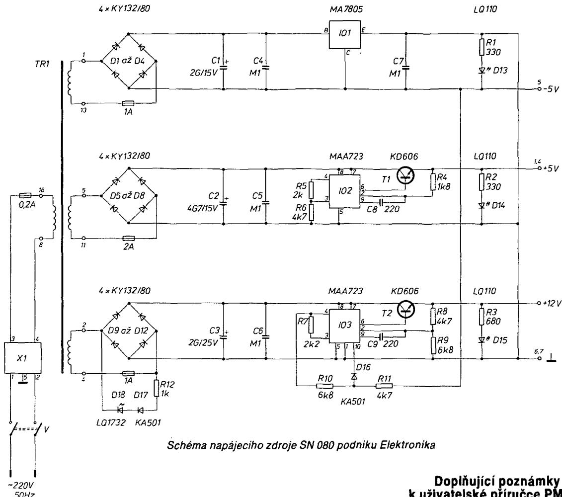
Schéma napájecího zdroje SN 080 podniku Elektronika
